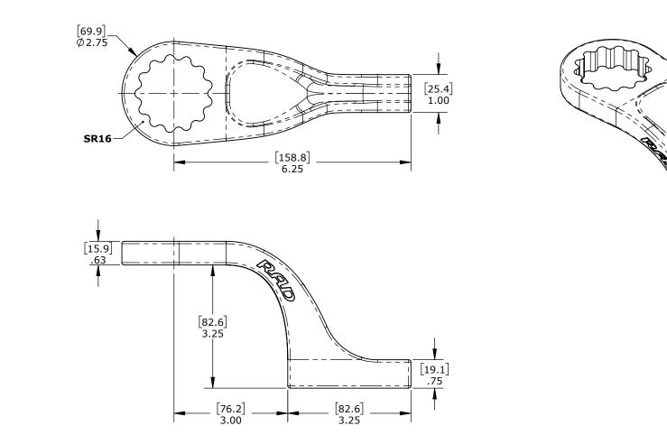
Suitable for: 15DX(-2), 20DX-M(-2), B-RAD 1500(-2), B-RAD 2000-M(-2), V-RAD 1500, V-RAD 2000-M, E-RAD BLU 1500, E-RAD BLU 2000-M
