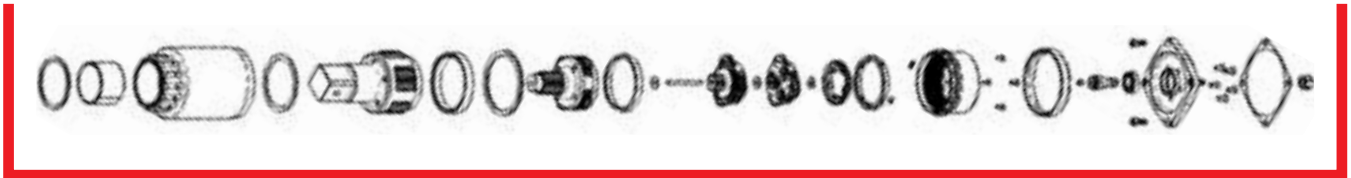
Despiece de la caja de engranaje RAD
